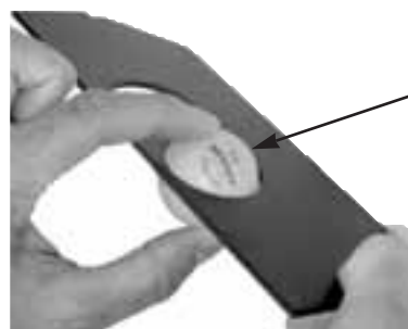
Abbildung 14 ÜBERPRÜFUNG DER BALLGRÖSSE MIT BALLDAMM (NUR 2040)
